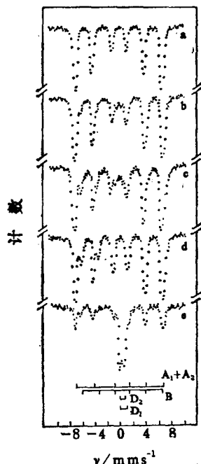
图 2 \gamma\text{-Li}_x\text{Fe}_2\text{O}_3 的 Mössbauer 谱 a— \gamma\text{-Fe}_2\text{O}_3 ; b— \text{Li}_{1.0}\text{Fe}_2\text{O}_3 ( i=0.25 \text{ mA}\cdot\text{cm}^{-2} ); c— \text{Li}_{1.5}\text{Fe}_2\text{O}_3 ( i=0.25 \text{ mA}\cdot\text{cm}^{-2} ); d— \text{Li}_{2.0}\text{Fe}_2\text{O}_3 ( i=0.05 \text{ mA}\cdot\text{cm}^{-2} ); e— \text{Li}_{1.5}\text{Fe}_2\text{O}_3 ( i=0.25 \text{ mA}\cdot\text{cm}^{-2} , 真空退火)
