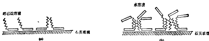
图3 Triton X-100 的吸附层模型
