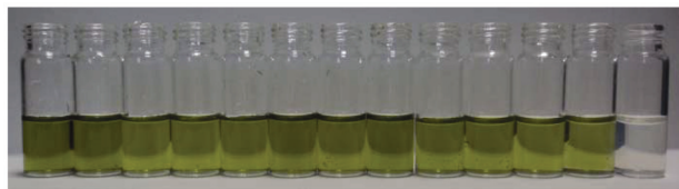
图1 在配合物 \text{CuL}_2 ( c=2.0 \times 10^{-5} mol/L) 的 \text{DMSO}/\text{H}_2\text{O} ( V:V=3:1 ) HEPES 缓冲溶液中, 分别加入不同阴离子( c=1.0 \times 10^{-3} mol/L)的比色效果图
