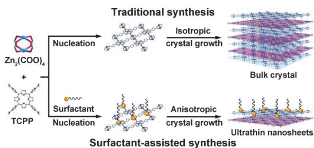
图7 表面活性剂辅助法合成超薄的 2D MOF 纳米片 [41]
