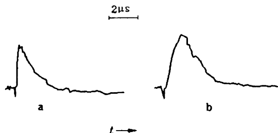
图 4 在图 3a 中的 4 号和 5 号峰强度的时间变化波形 微波功率: 4 \text{ mW} , (a) 4 号峰, (b) 5 号峰
