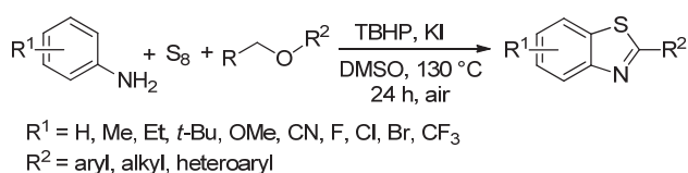
图式 34 TBHP/KI 介导苯胺、醚和元素硫的偶联反应 Scheme 34 Coupling of anilines, ethers, and elemental sulfur mediated by TBHP/KI
