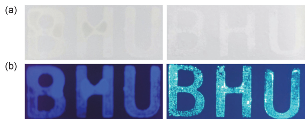
图 5 Tbia 作为隐形墨水的应用, 印在硅胶板上的 BHU 字母在日光(a)和紫外光(b)下的印迹
