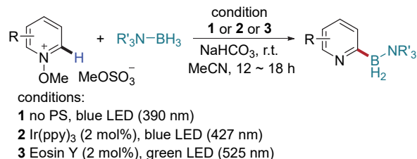
图式 17 氮杂芳环的光化学硼化反应 Scheme 17 Photochemical borylation of azines
