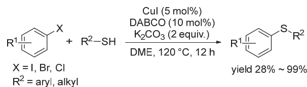
图式 13 \text{CuI}/\text{DABCO} 催化的芳基硫醚合成
